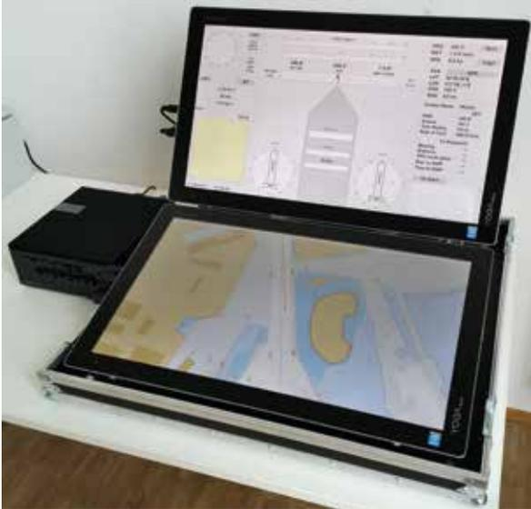
In einem Versuchsaufbau wird das Zusammenspiel zwischen dem entwickelten Prototyp einer mobilen Brückenkonsole und einem Bahnführungssystem für Schiffe getestet.
