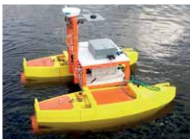
EITAMS_Ueberwasserfahrzeug: Der zurzeit ferngesteuerte Überwassergeräteträger der Jade Hochschule.
