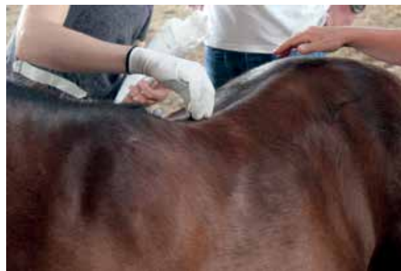
Auf dem Körper des Pferdes platziert Marilena Sydow die Marker für das optische, infrarotbasierte Bewegungserfassungssystem
