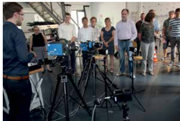
Die vorgeführten Kameras lassen sich durch Taktgeber starten und auch synchronisieren.
